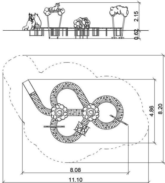
Ein Schwebebalken, der aus regenbogenfarbenen Plattformen in Kurven besteht, die mit zusätzlichen Vorrichtungen wie Portalen, Tunneln, Treppen und Rutschen durchsetzt sind. Plattformen aus mehrfarbigem HDPE auf einem Stahlrahmen, Tunnel aus Polycarbonat mit transparentem UV-Druck, vertikale Rutschen aus HPL mit UV-Druck.
