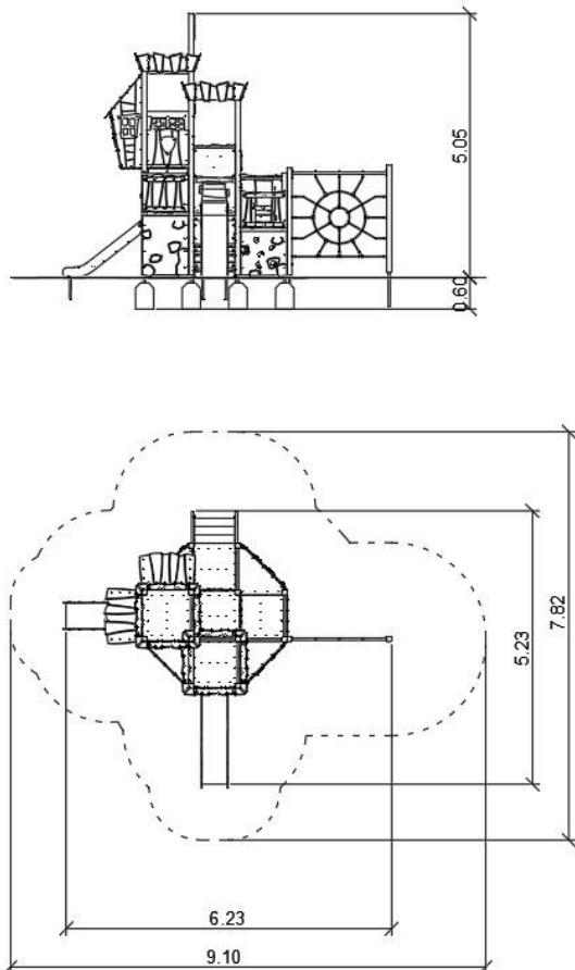
Einheit auf quadratischen Holzpfählen. Räume unter den Plattformen, die bis zur vollen Höhe mit Paneelen bebaut sind, wodurch Ecken und Tunnel entstehen. Schrägdächer aus HPL und HDPE. Gefräste Paneele mit Mustern, die an Bohlen und Steinmauern erinnern. Mit einer rutschfesten Beschichtung versehene Podeste. Erker auf Türmen mit einfachem Pultdach und Fenstern, mit Bänken im Inneren.
