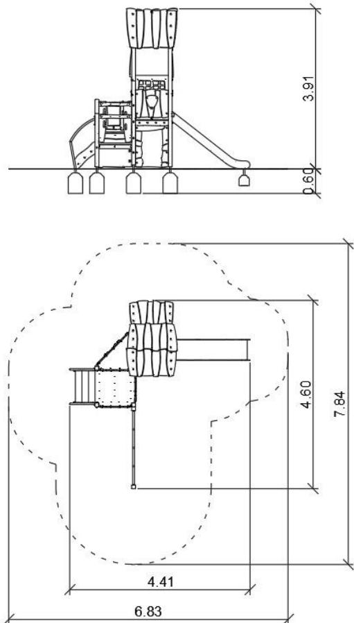
Einheit auf quadratischen Holzpfählen. Räume unter den Plattformen, die bis zur vollen Höhe mit Paneelen bebaut sind, wodurch Ecken und Tunnel entstehen. Schrägdächer aus HPL und HDPE. Gefräste Paneele mit Mustern, die an Bohlen und Steinmauern erinnern. Mit einer rutschfesten Beschichtung versehene Podeste. Erker auf Türmen mit einfachem Pultdach und Fenstern, mit Bänken im Inneren.
