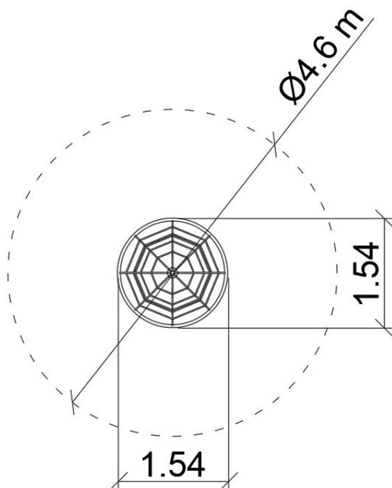
Urządzenie linowe w formie pionowego stożkowego lianarium rozszerzającego się ku dołowi. Obręcz spinająca liny wykonana ze stali nierdzewnej o średnicy 42,4 mm.
