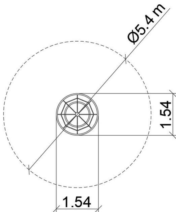
Urządzenie linowe w formie pionowego cylindrycznego lianarium zwężającego się w środkowej części. Górna i dolna obręcz wykonana ze stali nierdzewnej o średnicy 42,4 mm.
