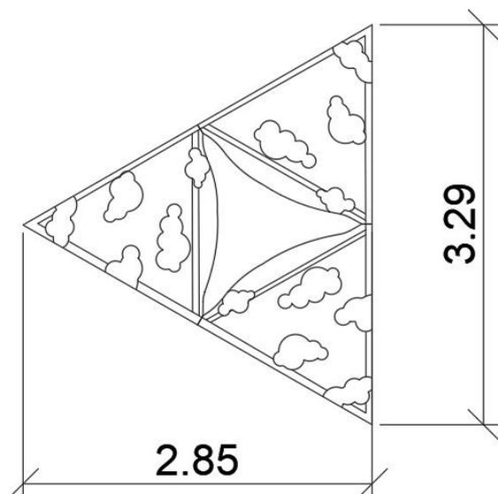
Jest to zadaszenie składające się z 3 trójkątnych dachów z poliwęglanu z nadrukiem UV, umożliwiającego zacienienie piaskownicy. Połacie dachu ułożone są pod kątem ułatwiającym zsuwanie się śniegu i spływanie deszczu.
