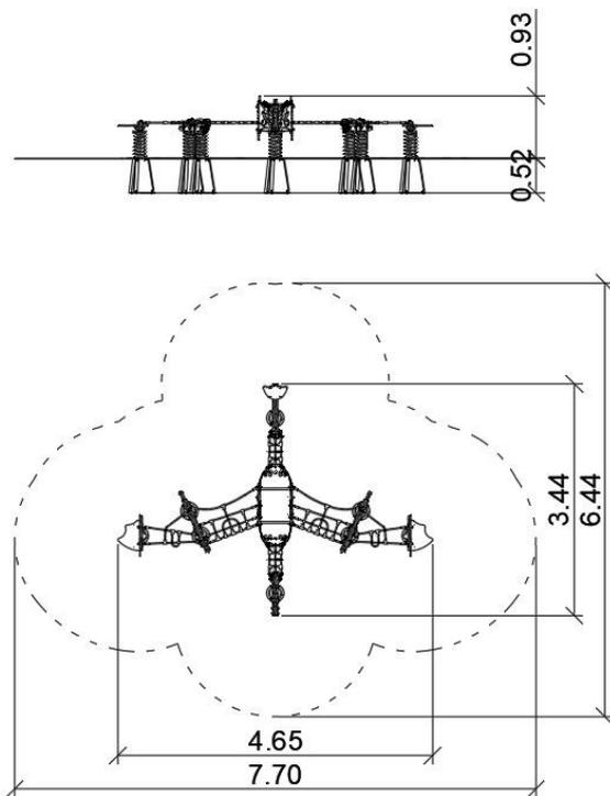
Urządzenie w kształcie smoka złożone z 7 modułów posadowionych na sprężynach i połączonych ze sobą linami. Środkowa część wykonana z giętego HDPE.
