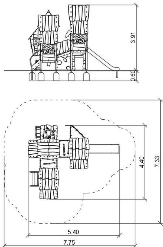
Urządzenie na drewnianych słupach o przekroju kwadratowym. Przestrzenie pod podestami zabudowane na całej wysokości płytami, tworzące zakamarki i tunele. Dachy dwuspadowe wykonane z HPL i HDPE. Płyty frezowane w wzory przypominające deski i kamienne mury. Podesty pokryte powłoką antypoślizgową. Na wieżach wykusze z jednospadowym dachem i oknami, w środku z ławkami.
