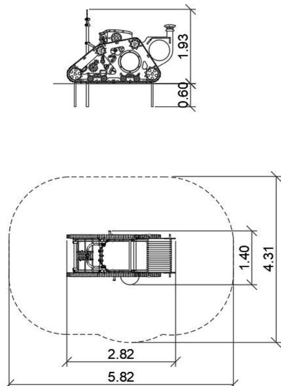
Dispositif en forme de char steampunk. Le dispositif est monté sur des poteaux ronds avec des supports en aluminium. Le dispositif se compose d'une plate-forme avec revêtement antidérapant, d'un tunnel tubulaire, de 8 engrenages, de 2 molettes, de 4 boutons, d'un volant, d'un filet de corde incliné, de deux rails en PEHD plié entourant les deux côtés du dispositif. Panneaux HPL recouverts de nombreuses impressions UV et de fraisages.
