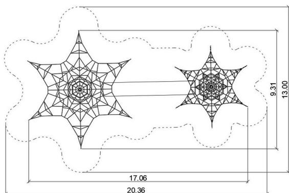
Dwie piramidy linowe o wysokości 6 i 4 metrów połączone mostem linowym rozpiętym na dwóch stalowych pylonach
