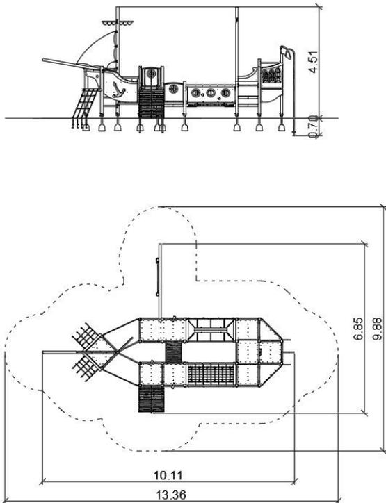
Urządzenie w formie statku z masztami, na drewnianych słupach o przekroju kwadratowym. Podesty pokryte powłoką antypoślizgową, barierki wzmocnione rurkami stalowymi na górze i na dole. Zwężki z spawanych rur stalowych.
